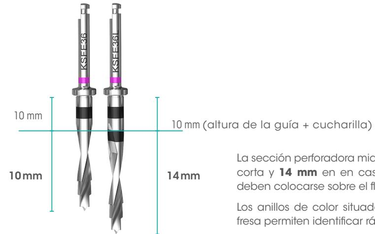
La sección perforadora mide **10 mm** en el caso de la fresa corta y **14 mm** en el caso de la fresa larga. Los topes deben colocarse sobre el flanco de la fresa.
